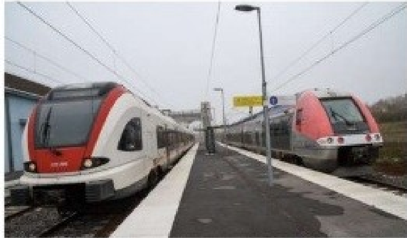
Pour pouvoir accueillir un train suisse et un TER français à égal en gare de Delle, SNCF Réseau a dû innover car les deux rames ne fonctionnent pas avec le même courant. Photo: Jérémy
