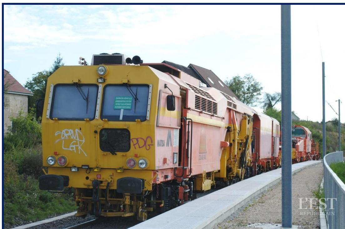
Si sur les rails de la future ligne Belfort-Delle, on ne voit pas encore de train, on peut quand même voir des machines ferroviaires de l'entreprise Colas qui règlent au millimètre près l'écartement et la hauteur des rails, ainsi que les valeurs des courbes et le niveau du ballast.
