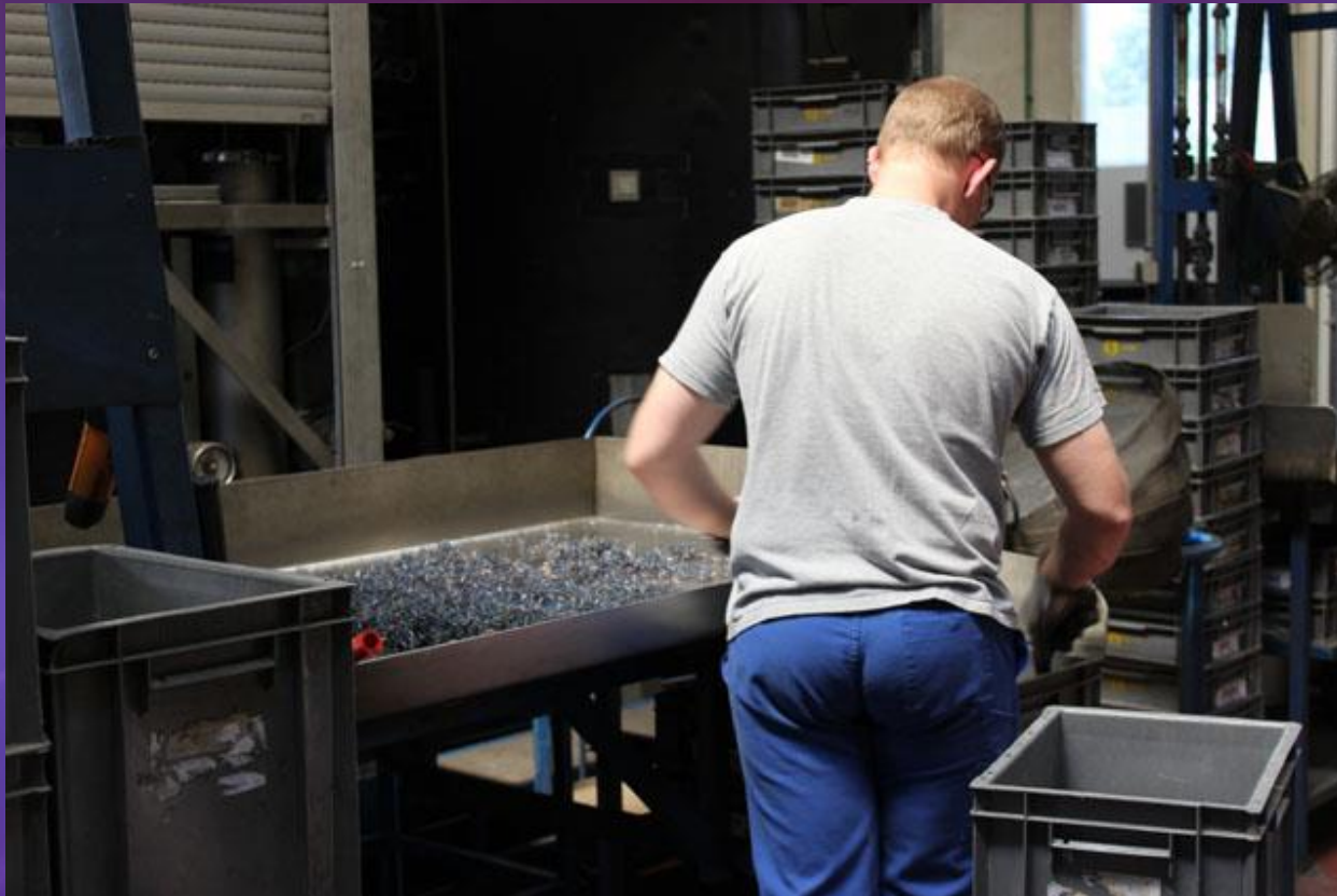
Atelier de trempe – Dégraissage des hameçons
